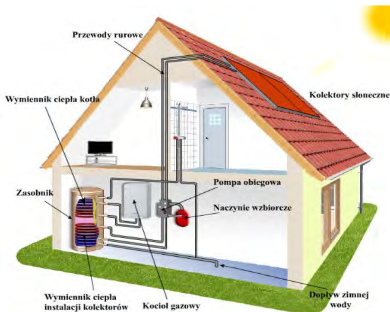
Ryc. 13. Schemat instalacji kolektorów słonecznych w domu jednorodzinnym
